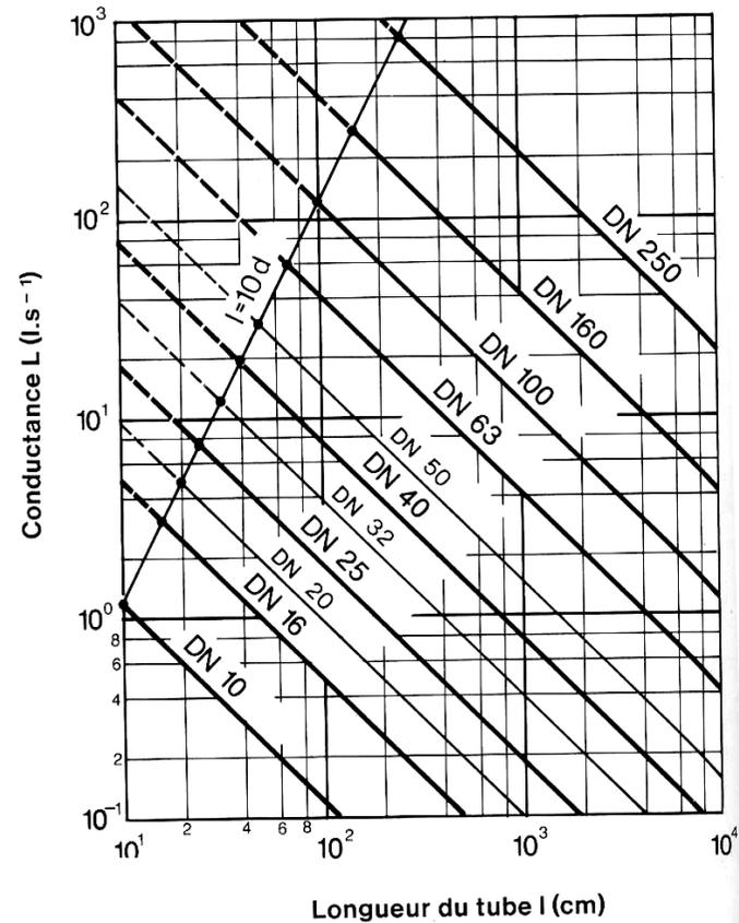
Écoulement moléculaire air à 20°C
