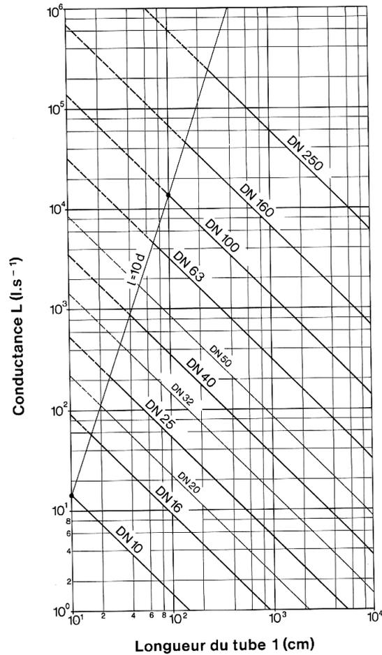
Écoulement laminaire air à 20°C
